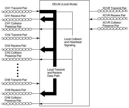
Figure 3–1 LOCAL Mode Signal Flow Diagram
