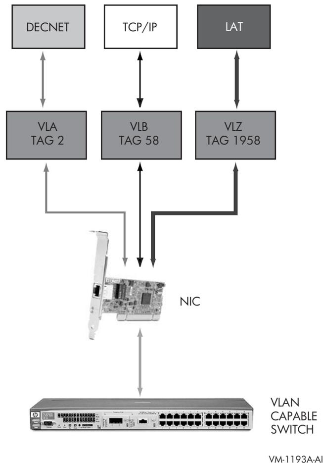
OpenVMS VLAN は、仮想 LAN デバイスを提供する新しいドライバ SYSSVLANDRIVER.EXE を通して実装されています。また既存の LAN ドライバは、VLAN タグを処理できるように変更されています。LANCP.EXE および
